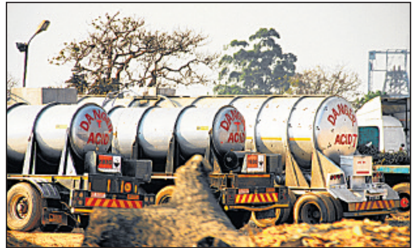
Dans des camions, l'acide utilisé en quantité pour extraire le cuivre.
